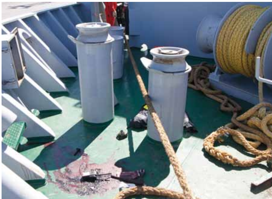
Det trånga fördäcket. Till höger trosspelet med det avslitna springet. Foto Polisen.
