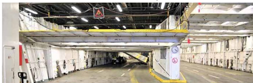
Bildäcket på M/S Eckerö samma dag som olyckan skedde. Den nedfallna plattform tre syns långt bak i mitten av bilden. Foto: Haverikommissionen
